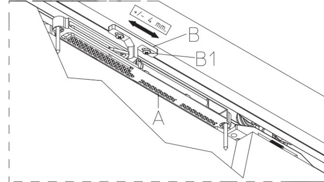
\*Installato il pannello, portarlo in chiusura ed apertura e regolare, se necessario, la staffa "B" allentando le viti "B1".
