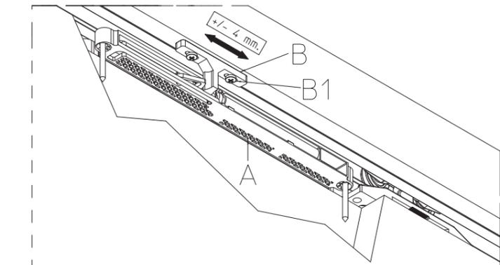
\*Nach Einbau des Türblatts, dieses in Schließungs- und Öffnungsposition bringen und, falls notwendig, Lasche „B“ regulieren indem man die Schrauben „B1“ lockert.
